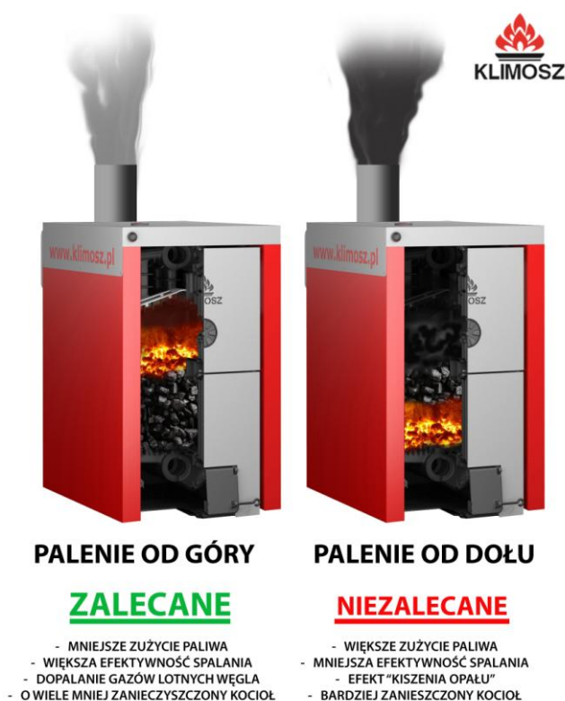
Rys.13. Schemat palenia od góry i od dołu.
